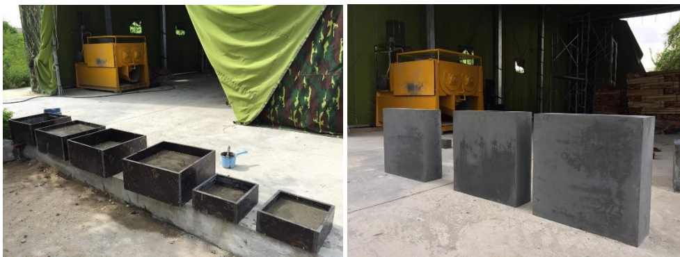
Hình 4. (a) mẫu bê tông được đổ vào khuôn; (b) tấm bê tông sau khi được chế tạo.
