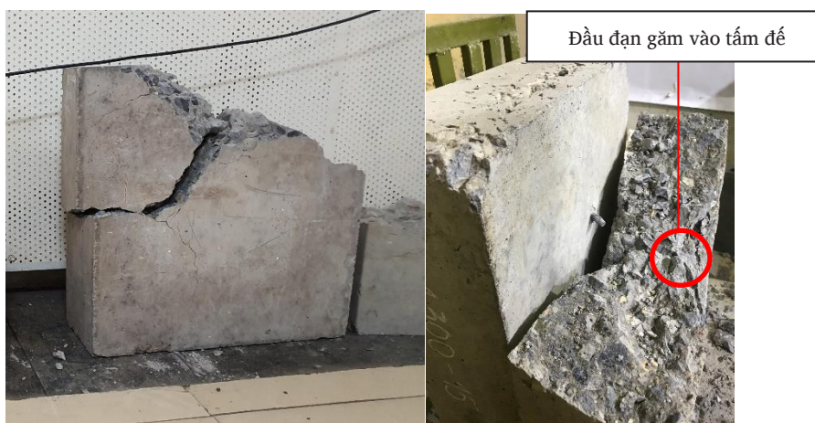
Hình 8. Bề mặt mẫu MX10-Đ bị phá hoại sau khi thử đạn xuyên.
