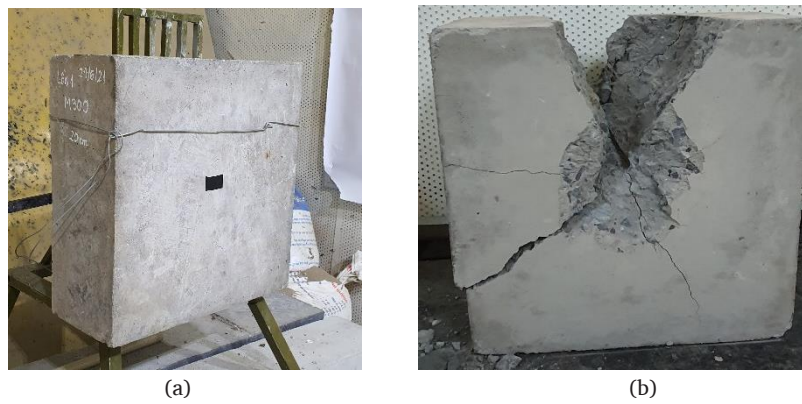
Hình 10. Bề mặt mẫu MX20-Đ: (a) trước khi thử nghiệm xuyên; (b) sau khi thử nghiệm xuyên.
