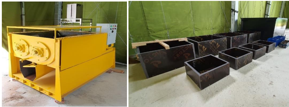
Hình 3. (a) máy trộn bê tông; (b) khuôn đúc mẫu và thùng bảo dưỡng bê tông.
