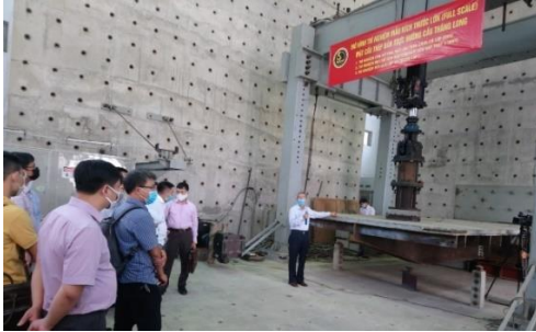
Hình 4. Mô hình lớn thử nghiệm lớp UHPC liên hợp bản mặt thép trực hướng OSD.
