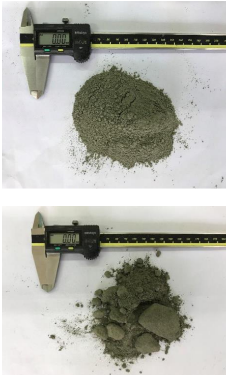
Hình 1. Vật liệu sản xuất cốt liệu nhẹ: (a) Xi măng và (b) Tro bay.
