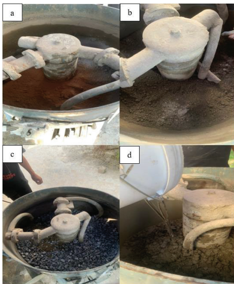
Hình 3. Quy trình nhào trộn hỗn hợp bê tông bao gồm trộn khô hỗn hợp cát, xi măng và bùn (a), cát, xi măng và bùn sau khi trộn 30 giây (b), cho đá dăm vào trộn (c) và cho phần nước có phụ gia vào trộn (d).
