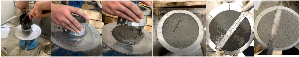
Hình 4. Xác định độ xòe của hỗn hợp bê tông cường độ cao hạt mịn trong côn vữa.
