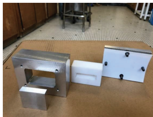
Hình 3. Khuôn chế tạo mẫu thí nghiệm.
