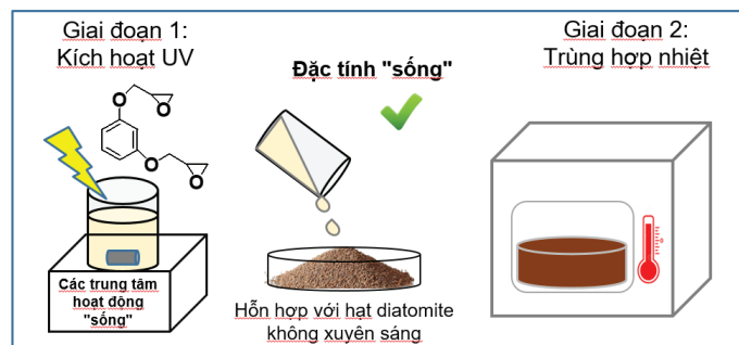
Hình 2. Chế tạo composite epoxy – diatomite thông qua quá trình 2 giai đoạn dưới tác dụng của tia UV và nhiệt.
