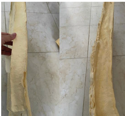
Hình 11. Tấm xốp tạo thành khi thay thế 50 và 60 % polyol thương mại.
