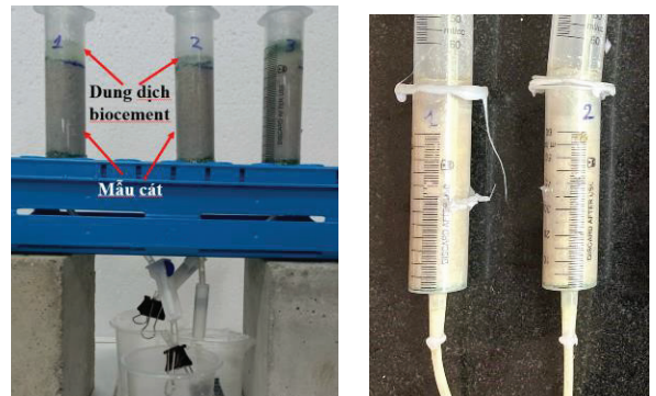
Hình 3. Kỹ thuật hóa cứng cột cát rời dùng xi măng sinh học EICP.
