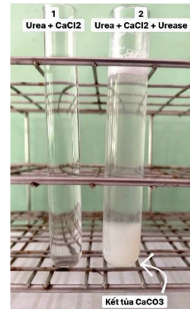
Hình 6. Kiểm tra kết tủa CaCO 3 trong ống nghiệm.
