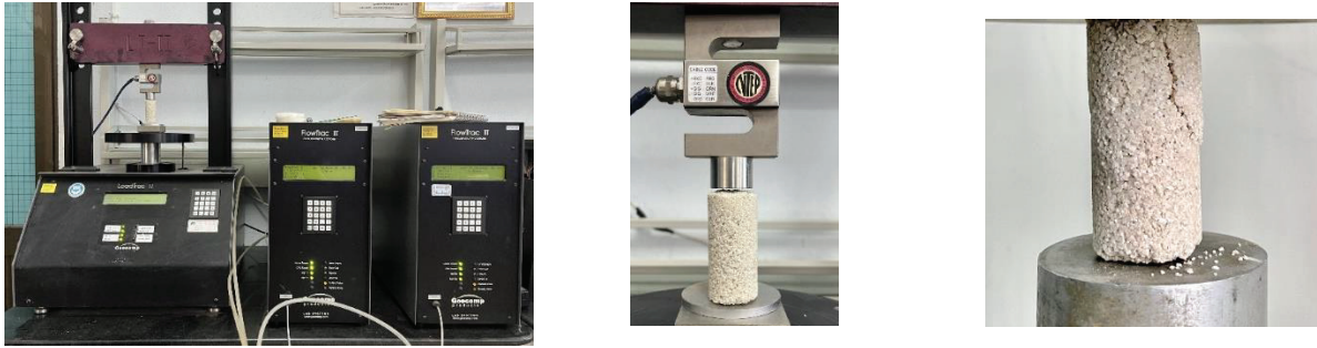
Hình 5. Kiểm tra cường độ của mẫu cát bằng hệ thống máy nén Loadtrac II Geocomp.
