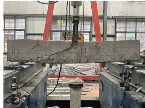
Hình 9. Dầm bị phá hủy.
