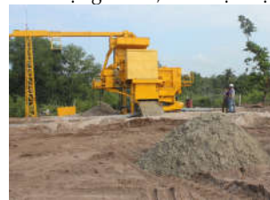
Hình 8. Dây chuyền xử lý cát biển theo công nghệ Công ty Phan Thành tại Phú Quốc
