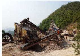
Rửa cát bằng nước tại sàng rung
