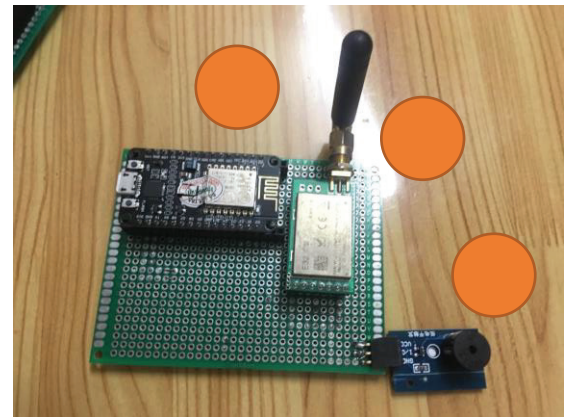
Hình 11. Mạch Receiver đặt ở ban quản lý với Lora E32 (1), buzzer (2), vi điều khiển ESP8266 - NodeMCU (3).
