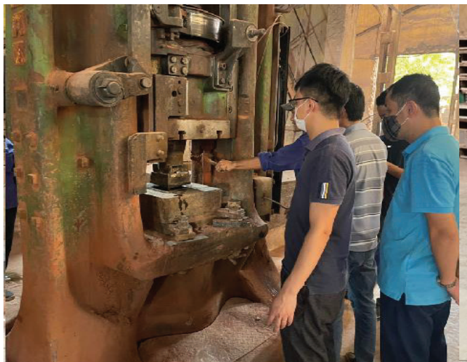
Hình 3. Lắp đặt và hiệu chỉnh khuôn ép đập
