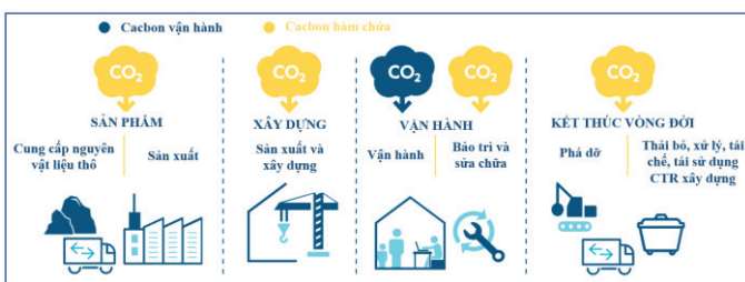
Hình 1. Phát thải cacbon vận hành và cacbon hàm chứa trong toàn bộ vòng đời của tòa nhà.
