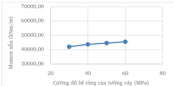
Hình 14. Momen âm lớn nhất trong móng bè khi cường độ bê tông tường thay đổi.
