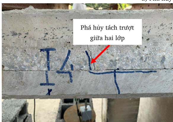
b) Phá hủy tách giữa hai lớp bê tông trên tấm sàn P1-N (1.6)
