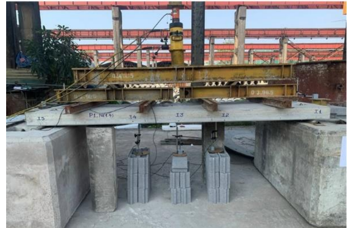
Hình 5. Hình ảnh bố trí hệ gia tải và thiết bị thí nghiệm tấm sàn panel đặc.
