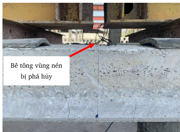
a) Phá hủy bê tông của tấm sàn P1
