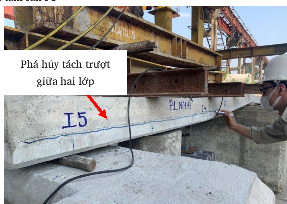
c) Phá hủy tách giữa hai lớp bê tông trên tấm sàn P1-N (1.4)
