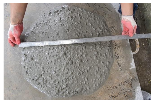
Hình 1. Độ chảy loãng của hỗn hợp bê tông.
