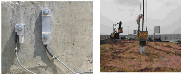
(a) Các đầu đo thí nghiệm PDA (b) Thí nghiệm PDA ngoài hiện trường Hình 3. Các đầu đo (a) và thí nghiệm PDA ngoài hiện trường (b)
