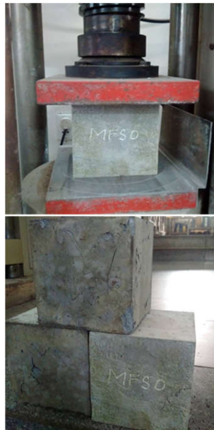
Hình 2. Thử cường độ chịu nén và dạng vết nứt sau khi nén.
