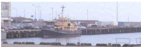
Hình 17. Lớp xe được sử dụng làm chắn bùn neo đậu trên cầu cảng Lowestoft [13].
