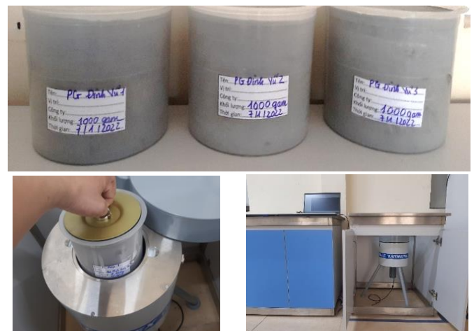
Hình 3. Thử nghiệm hoạt độ phóng xạ các mẫu PG nghiên cứu.
