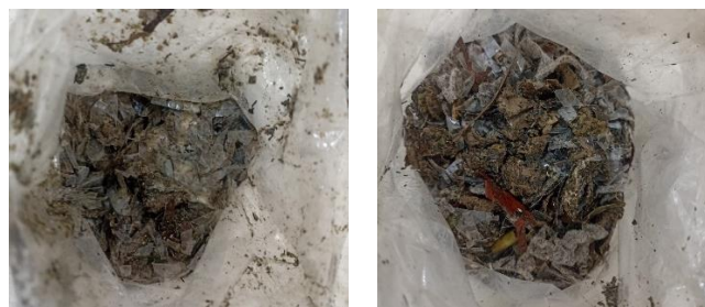
Hình 4. RDF chế tạo từ CTRSH.
