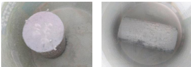
Hình 7. Mẫu BTCS bị khoáng hóa trong quá trình thử nghiệm.
