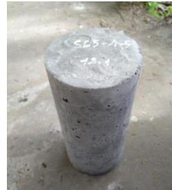
Hình 4. Mẫu BTCS sau khi dưỡng hộ 28 ngày chuẩn bị ngâm nước thí nghiệm.
