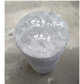
Hình 4. Mẫu BTCS sau khi dưỡng hộ 28 ngày chuẩn bị ngâm nước thí nghiệm.
