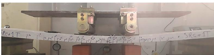
b) Hình dạng phá hoại của mẫu sàn thí nghiệm [12].
