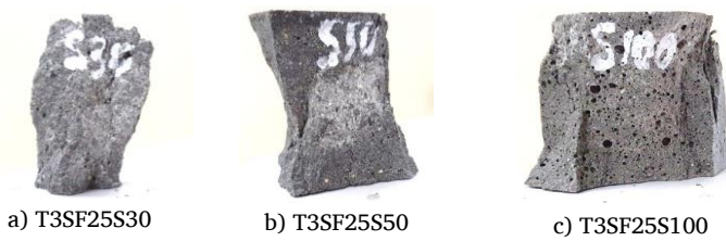
Hình 8. Hình ảnh các mẫu bê tông hạt mịn với hàm lượng xi thép khác nhau.
