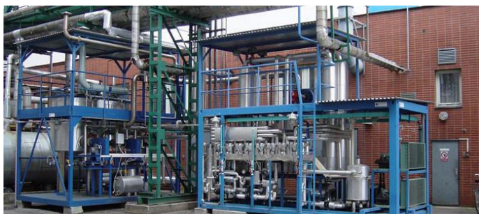
Hình 7. Hệ thống thu hồi VOC ngưng tụ trong nhà máy dược phẩm.
