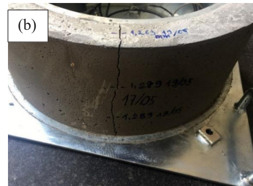
Hình 7. Vết nứt xuất hiện trong mẫu (a) NC với mức M350 và (b) HC với mức M600.
