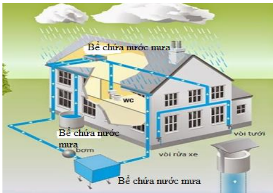
(a) Bể chứa nước mưa
