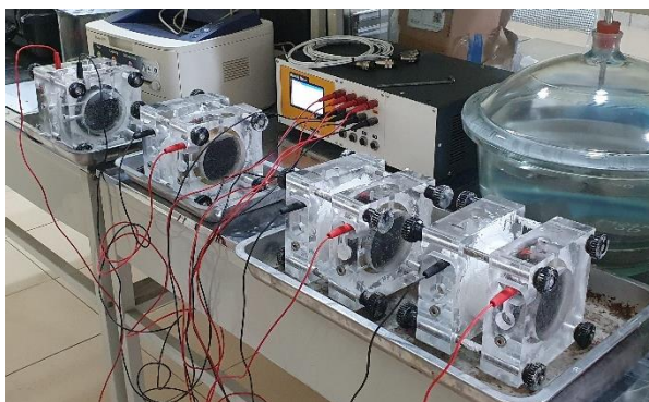
(a) Thí nghiệm đo độ thẩm thấu ion Clo
