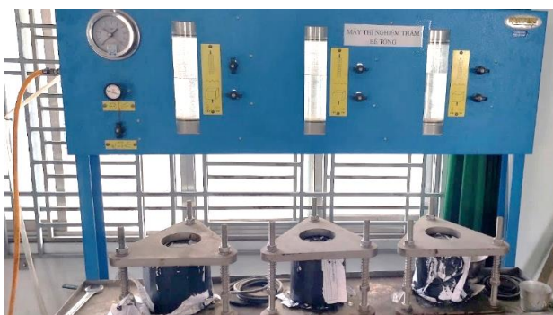
Hình 7. Máy thử độ chống thấm nước.
