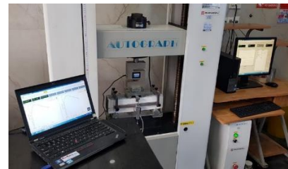
Hình 2. Thí nghiệm xác định cường độ chịu kéo khi uốn của mẫu đầm UHPC.
