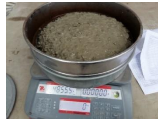
Hình 3. Thí nghiệm tính công tác hỗn hợp SCC.
