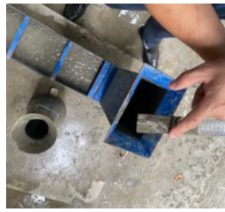
Hình 3. Thí nghiệm tính công tác hỗn hợp SCC.
