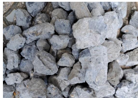
(b) RCA được chế tạo từ phế thải bê tông
