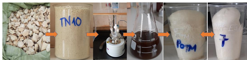
Hình 2. Từ xốp PU phế thải cho đến xốp PU tái sinh (từ polyol tái sinh thu được nhờ quá trình glycolysis).
