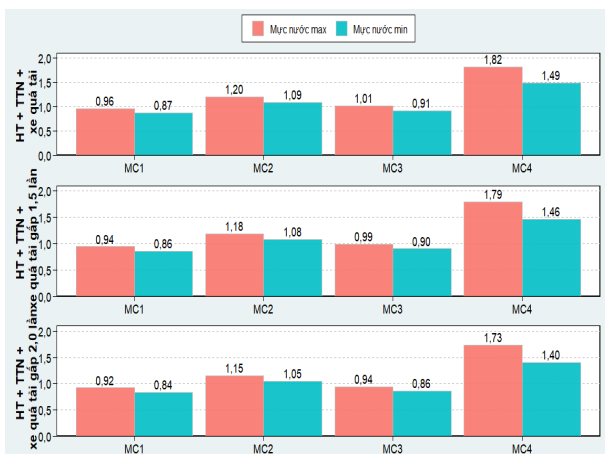
Hình 11. Giả định tải do xe quá tải (TH3) và giả định tải trọng xe quá tải thiết kế từ 1,5 (TH4) đến 2,0 lần (TH5).
