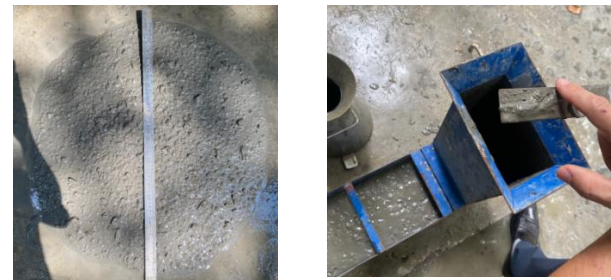
Hình 2. Thí nghiệm tính công tác hỗn hợp BTTL.
