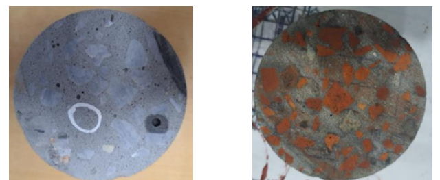
Hình 3. Mặt cắt BTTL ở độ tuổi 28 ngày.
