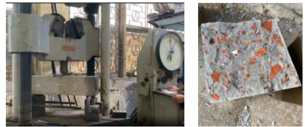
(a) Thí nghiệm uốn mẫu RBCA100 (b) Bề mặt phá hủy mẫu RBCA100
