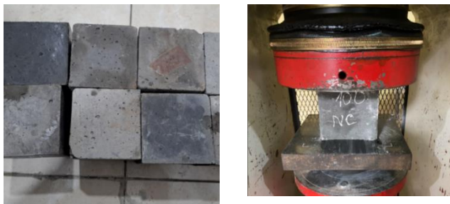
(a) Chuẩn bị mẫu nén (b) Thí nghiệm nén mẫu Hình 4. Thí nghiệm nén mẫu BTTL.
