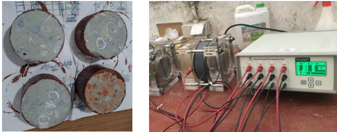
(a) Chuẩn bị mẫu (b) Thí nghiệm đo RCPT Hình 8. Thí nghiệm đo độ thẩm ion clorua.
