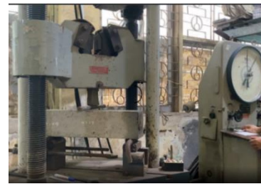
(a) Thí nghiệm uốn mẫu RBCA100
