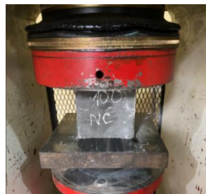
(a) Chuẩn bị mẫu nén (b) Thí nghiệm nén mẫu
