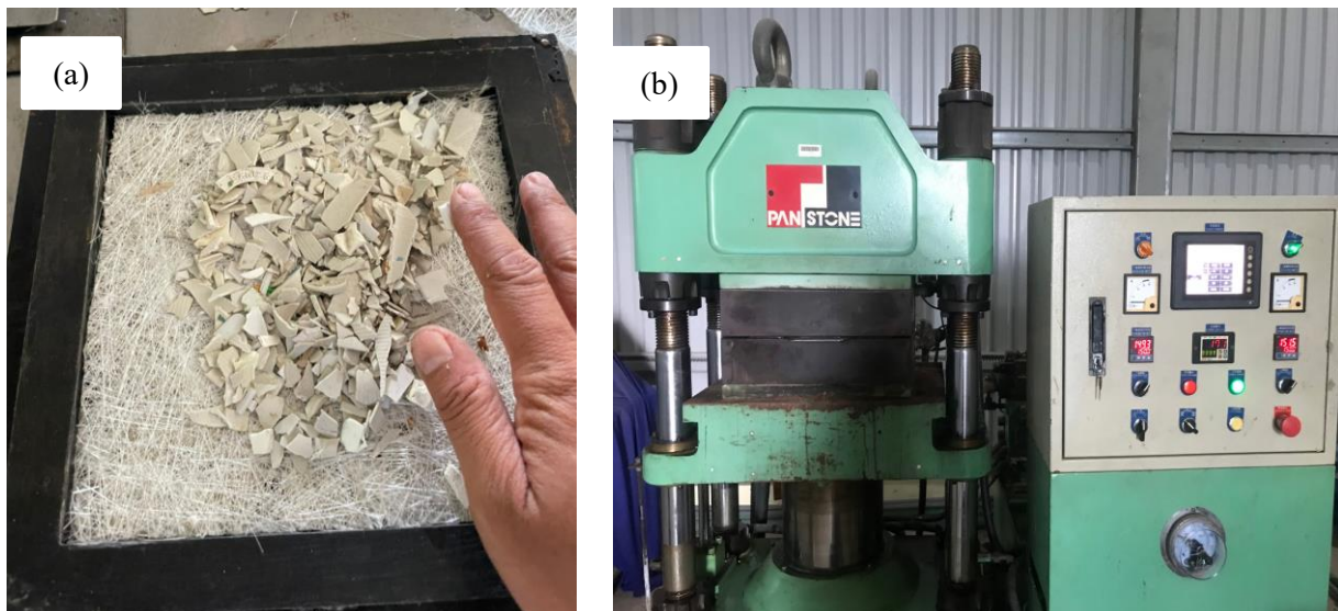
Hình 3. Đổ nhựa và ép nhựa (a) Trãi đều một lớp sợi thủy tinh và đổ nhựa vào khuôn và (b) Máy ép nhiệt đang vận hành.
