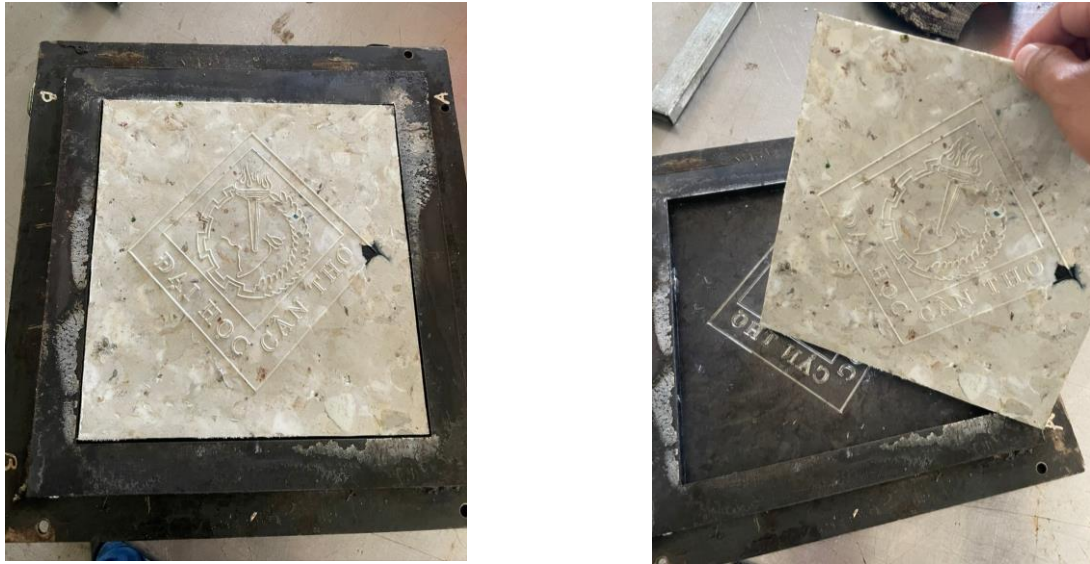
Hình 4. Làm nguội và tháo nắp khuôn (a) Sau khi làm nguội khuôn và (b) Gạch sau khi tháo khuôn.
