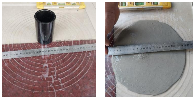
Hình 4. Xác định độ chảy của vữa chế tạo từ cát nhân tạo Ninh Thuận.
