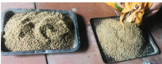
Hình 1. Cát nhân tạo nghiền từ đá granite (Ninh Thuận).
