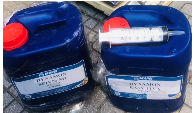
Hình 3. Phụ gia Dynamon Easy 11 và Dynamon SP1 sử dụng trong nghiên cứu.
