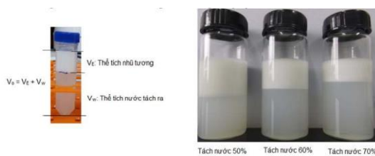
Hình 5. Tính tỷ lệ tách nhũ để đánh giá độ ổn định của chế phẩm.
