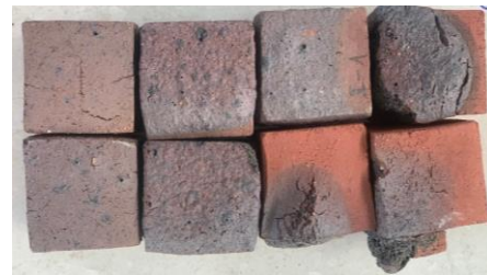
Hình 8. Hình ảnh gạch khí nung ở nhiệt độ 1050 °C.
