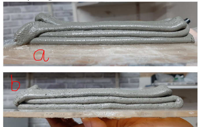
Hình 15. In 3 lớp chồng lên nhau (a. 0 % sợi PP; b. 1 % sợi PP).
