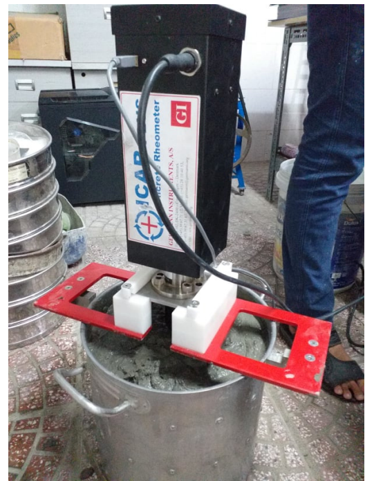
Hình 7. Đo lưu biến hỗn hợp bê tông.
