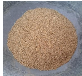
Hình 1. Mùn cưa cỡ hạt 0,6 ÷ 1,2mm.
