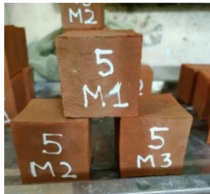
Hình 15. Mẫu sau khi ngâm bão hòa nước.
