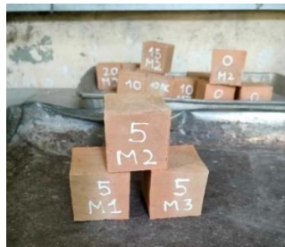
Hình 14. Mẫu trước khi ngâm nước.
