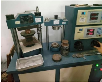
Hình 18. Thí nghiệm nén mẫu.
