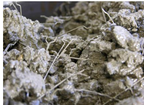
Hình 1. Độ sụt và hỗn hợp bê tông ứng với các cấp phối khác nhau.
