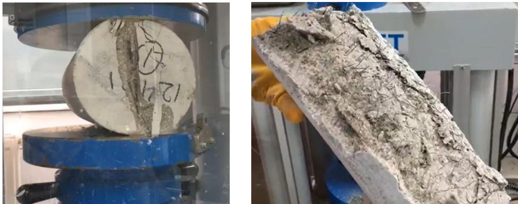
Hình 4. Thí nghiệm xác định cường độ kéo khi ép chèn.
