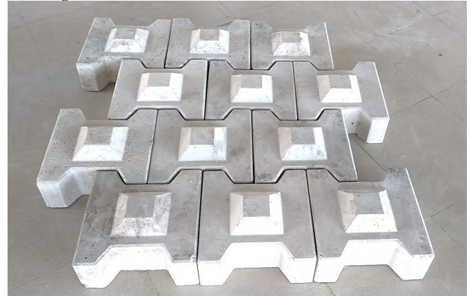
Hình 3. Mẫu gạch bê tông tự chèn được chế tạo trong nghiên cứu.
