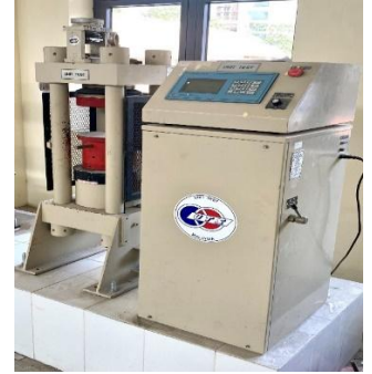
Hình 4a. Thiết bị thử cường độ uốn. Hình 4b. Thiết bị thử cường độ nén.
