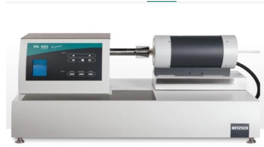
Hình 3. Thiết bị đo hệ số giãn nở nhiệt.
