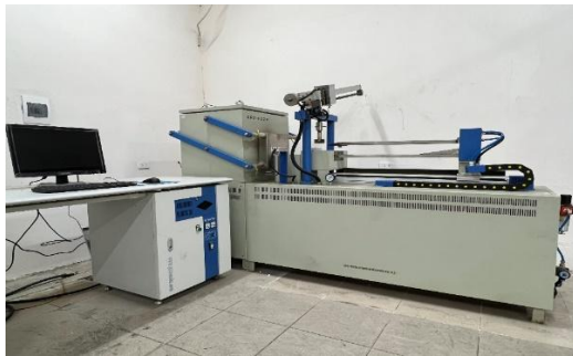
Hình 2. Thiết bị thử độ bền sốc nhiệt.
