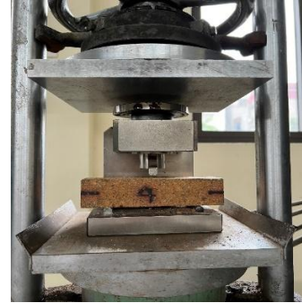
Hình 4a. Thiết bị thử cường độ uốn. Hình 4b. Thiết bị thử cường độ nén.
