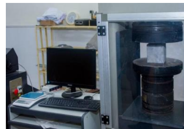
Hình 7. Hệ thống máy nén uốn tự động ADVANTEST 9.
