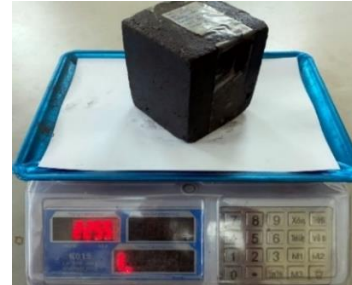
Hình 5. Xác định khối lượng và kích thước của mẫu bê tông thí nghiệm.
