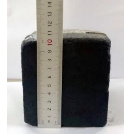
Hình 5. Xác định khối lượng và kích thước của mẫu bê tông thí nghiệm.
