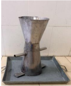
Hình 3. Bộ côn hình nón cắt tiêu chuẩn kích thước 10x20x30 cm.
