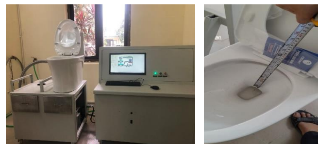
Hình 2. Thí nghiệm thể tích xả, thể tích xả sau.
