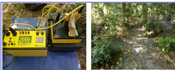
Hình 4. Máy Super-Sting R1 / IP đang thực hiện khảo sát số liệu ngoài thực địa.
