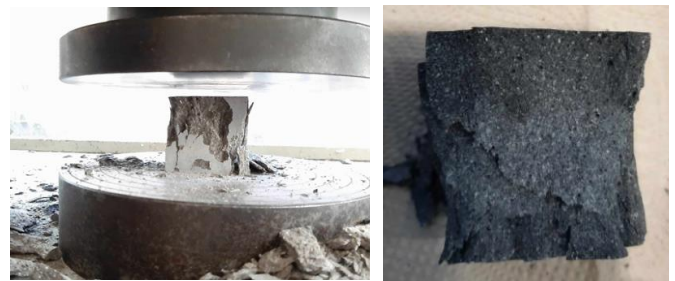
Hình 3. Thí nghiệm kiểm tra cường độ nén.
