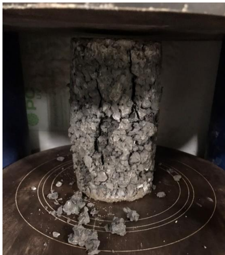
Hình 9. Mẫu PC bị phá hoại khi thí nghiệm nén mẫu.
