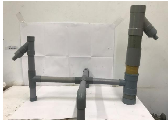
Hình 3. Sơ đồ mô hình thí nghiệm hệ số thấm của PC.
