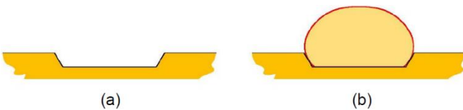
Hình 4. Thi công nền móng chìm: (a) nạo vét nhỏ trước khi đào (độ sâu 0,3 ~ 0,5m) và (b) đặt và lắp đầy ống địa kỹ thuật.
